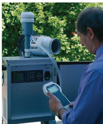
FlowCal used with TCR Tecora High Volume sampler, Echo HiVol
