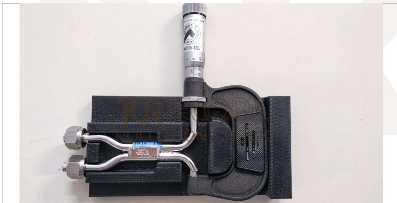
Foto 1: Particolare del posizionamento del Pitot S (n°2631) su dima fatta circolare dai partecipanti
