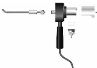
Il campionatore **EasyGas** può essere utilizzato con la sonda di prelievo per composti gassosi.
